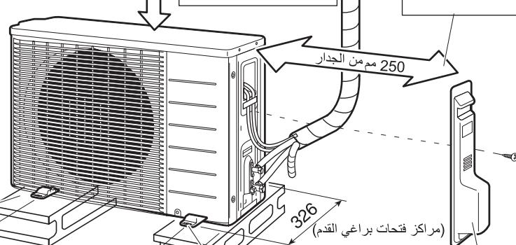
في المواقع ذات الصرف الضعيف، استخدم قواعد التجميع للوحدة الخارجية. واضبط ارتفاع القدم حتى تصبح الوحدة في وضع مستقر. وإلا، فقد يحدث تسرب أو تجميد للمياه.
